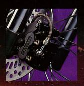
DUAL PISTON CALIPER BRAKES
