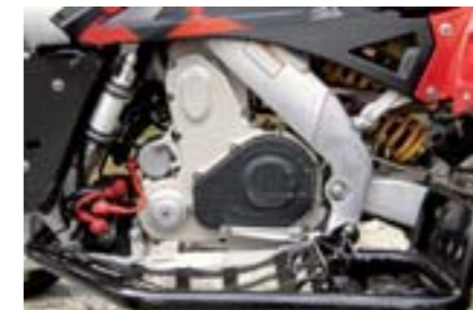
Podemos ver cómo la tapa del motor (invertido) es de una sola pieza. En esta unidad 2006 aún se puede ver el logo de Cannondale.
