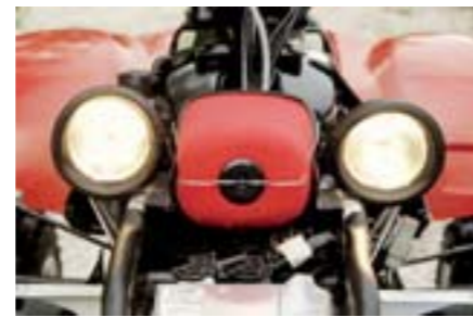
El filtro de aire se encuentra en el frontal del quad.
