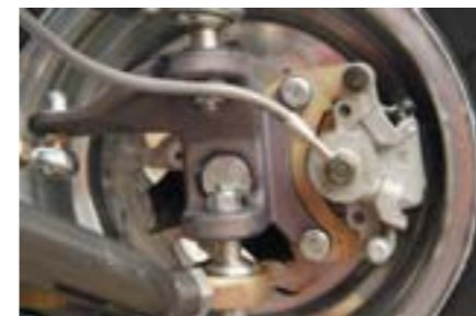
La frenada se encomienda a una pinza de un solo pistón y a unos discos lobulados Galfer.
