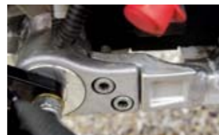
El chasis es desmontable. Está compuesto de dos piezas para poder extraer el motor fácilmente.
