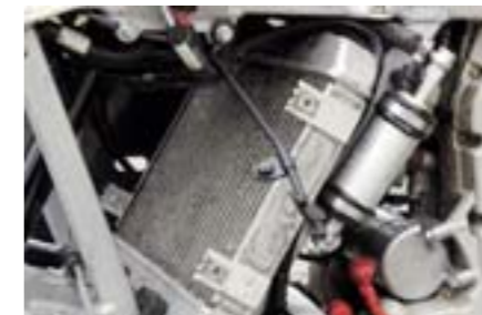
El radiador está montado con unos grados de inclinación para mejorar la refrigeración.
