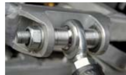
Los trapecios van montados al chasis y a los bujes mediante rótulas, lo que evita torsiones de los primeros.
