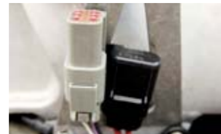
Con este enchufe, ubicado en el lado izquierdo, debajo el faro, podemos variar los mapas de inyección.
