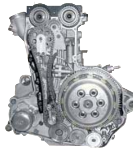
El motor desde dentro. Toda una obra de arte de 446 c.c. y 49 CV de potencia.
