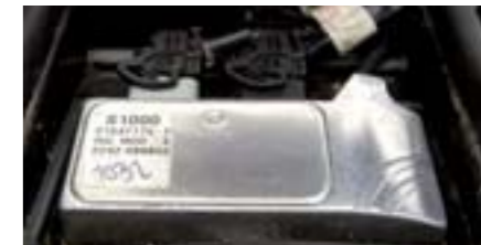
Un detalle del encendido que a su vez realiza funciones de caja de filtro.
