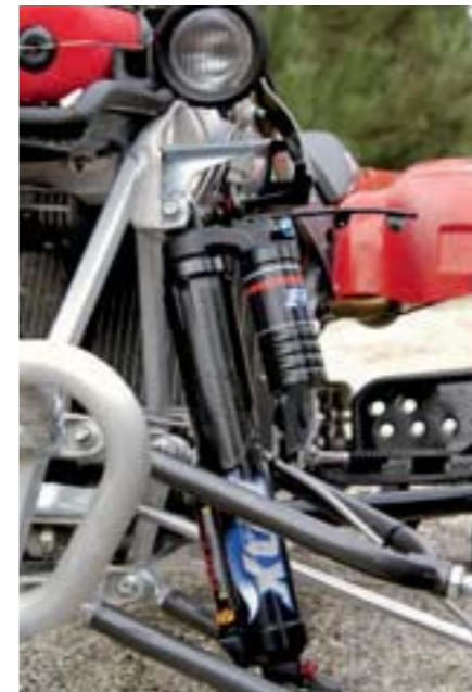
El ATK 450 de 2006 monta las suspensiones Fox Float X Evol, aunque en la versión 2007 ya llevará unas Pep's.
