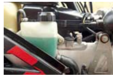
En el frontal, al lado del depósito del líquido refrigerante, se encuentra un tapón del depósito de aceite del motor, integrado en el chasis.
