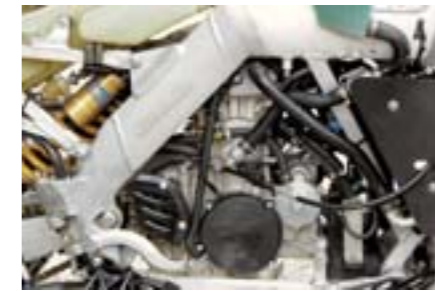
El chasis es de doble viga de aluminio perimetral.
