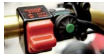
El interruptor del encendido y el del arranque eléctrico están situados en el lado izquierdo.
