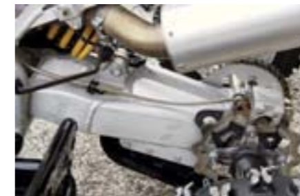
El basculante es de aluminio y el amortiguador trasero no dispone de bieletas.
