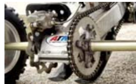
El disco trasero es lobulado y el basculante de aluminio.
